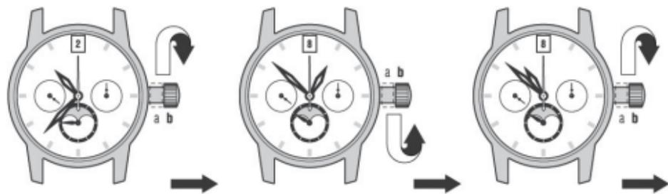
**ПРИМЕЧАНИЕ:** При переводе часовой стрелки следите за правильностью установки времени до или после полудня. Часы спроектированы так, что переключение календаря происходит один раз в сутки — в 12 ч. ночи. Перевод часовой стрелки через 12 часовую отметку характеризует устанавливаете Вы время до или после полудня. Если смена календаря произойдет, Вы будете устанавливать время до полудня, если нет — после полудня.
